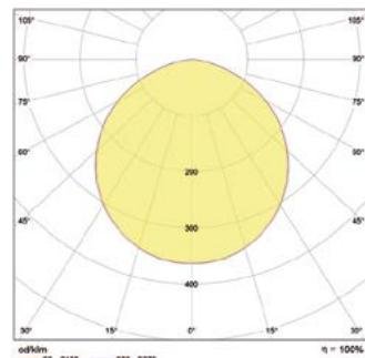
Photometry for one module • Fotometria dla jednego modułu • Photometrie für ein Modul
